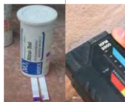
Misurazione sali dell'intonaco
